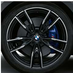
19" M 라이트 알로이 휠 더블 스포츠 스타일 792M 바이칼러 제트 블랙, 혼한 타이어 및 런플랫 타이어, 유광, 휠 크기 프론트 8J x 19 225/40 R19 타이어 휠 크기 리어 8.5J x 19 255/35 R19 타이어. *BMW M340i
