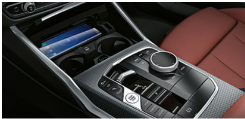
무선 충전 트레이는 케이블 없이 최대 15W의 전력으로 스마트폰을 편리하게 충전할 수 있으며 냉각 기능으로 스마트폰의 과열을 방지합니다.
