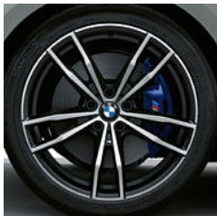
19" M 라이트 알로이 휠 더블 스포츠 스타일 791M 바이칼러 제트 블랙, 혼한 타이어, 유광, 휠 크기 프론트 8J x 19 225/40 R19 타이어 휠 크기 리어 8.5J x 19 255/35 R19 타이어. *BMW 330e M 스포츠
