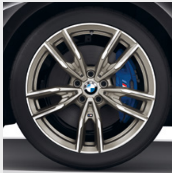
19인치 M 경합금 휠 2 더블 스포크 스타일 792 M 바이컬러 세리움 그레이, 혼합 타이어 및 안전 타이어, 매트, 프론트 휠 사이즈 8J x 19 (225 / 40 R19 타이어), 리어 휠 사이즈 8.5J x 19 (255 / 35 R19 타이어)
